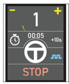
Su mezcladora dispone de una función de intervalo. El modo de intervalo permite una mezcla más uniforme cuando se utilizan materiales más viscosos. Las funciones de tiempo también se pueden utilizar en el modo de intervalo.
